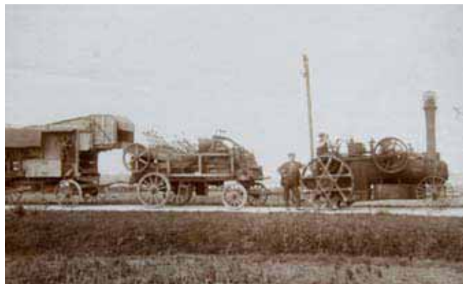
Lokomobil med transportabelt tærskværk. Fotografi fra 1919 af den kulfyrede og dampdrevne lokomobil, trækkende både vogn og tærskværk på vej til tærskarbejde et sted på Helnæs.
